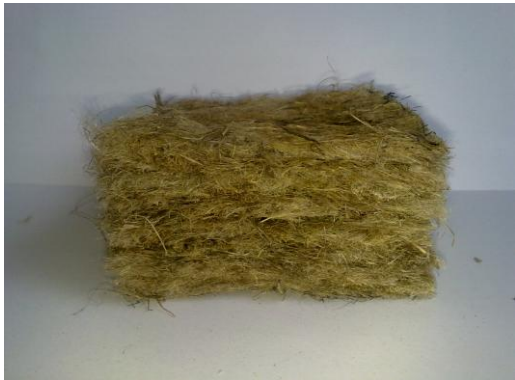
Fig.1. A1 Hemp fiber composite material
