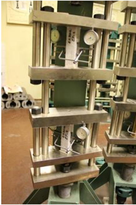
Fig. 3. Creep lever test stand
